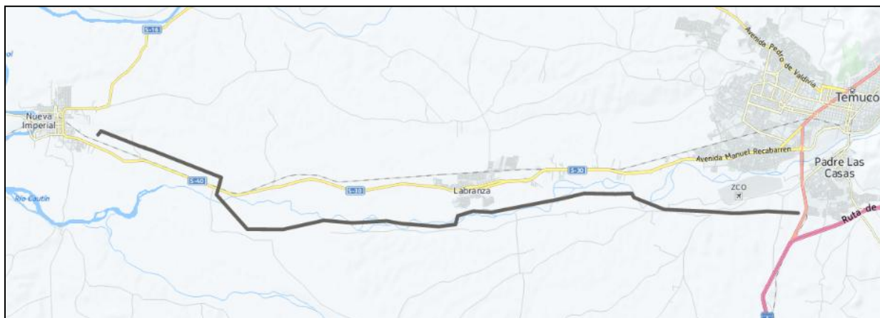
Figura 6.1.1. Línea de subtransmisión Licanco-Imperial 66 kV, que va entre las comunas Padre Las Casas y Nueva Imperial (Fuente: CNE, 2016).
