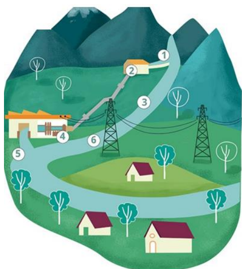
Figura 51: Esquema de operación de una central hidráulica de pasada
