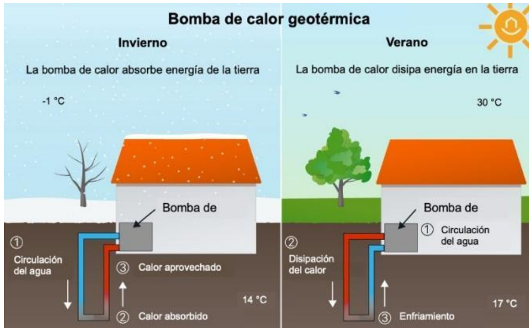
Figura 5-6: Funcionamiento de una bomba de calor geotérmica en invierno y verano. Fuente: (Noticias de la Ciencia y Tecnología, 2023).
