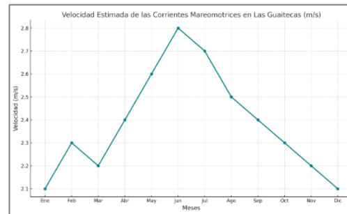
Figura N°32. Gráfico velocidad estimada corrientes Mareomotrices en Guaitecas (m/s)
