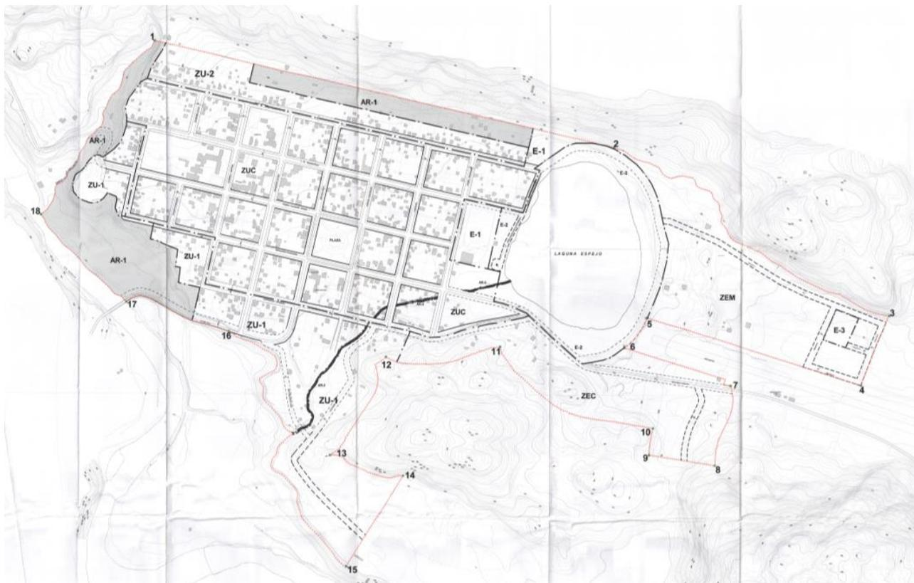
Figura 56. Plano regulador Futaleufú. ZUC: Centro comercial e institucionalidad; ZU-1: Residencial mixta media densidad; ZU-2: Residencial condicionado de baja densidad; E-1: Estadio y Medialuna; E-2: Laguna Espejo; E-3: Cementerio; ZEM: Expansión mixta y residencial de alta densidad; ZEC: Expansión comercial y residencial con densidad media; AR-1: Riesgo por pendiente elevada y deslizamientos; AR-2: Protección canal desagüe Laguna Espejo. Fuente: PRC aprobado en SEIA.
